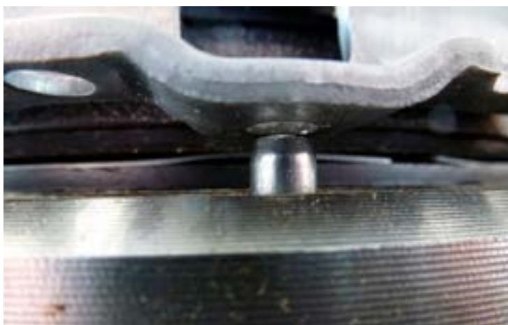
Εικόνα 1: Οι πείροι-οδηγοί δεν εφαρμόζουν στις αντίστοιχες τρύπες, κατά τη τοποθέτηση
