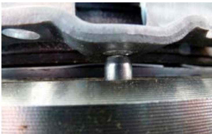
Рис. 1: Центрирующие штифты не вставляются в отверстия во время установки монтажа
