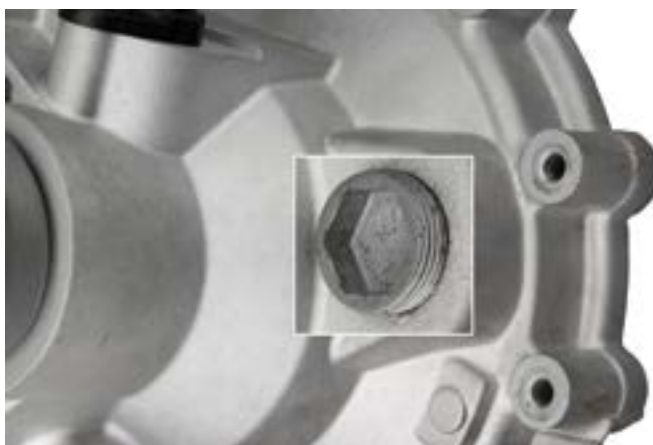
Obrázek 1: Provedení plnicího šroubu oleje s vnitřním šestihranem
