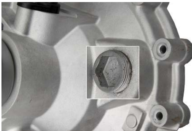
Εικόνα 1: Σχεδιασμός της τάπας πλήρωσης για κλειδί τύπου Άλλεν
