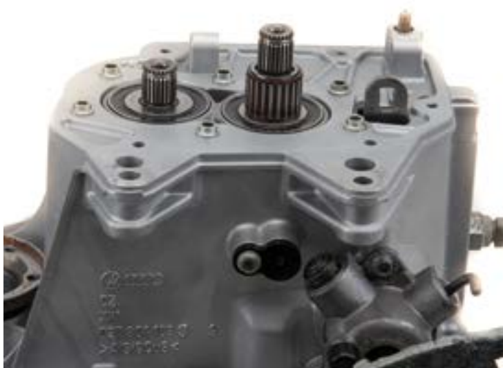
Brýlové a jehlové ložisko převodovky 02T
