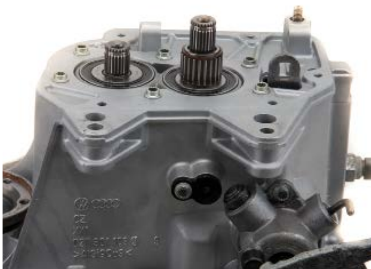
Το σύνολο των διπλών και των μακαρονωτών ρουλεμάν σε κιβώτιο 02T
