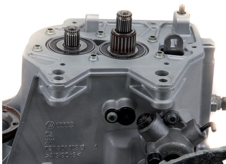
Roulement jumelle et roulement à aiguilles d'une BV 02T
