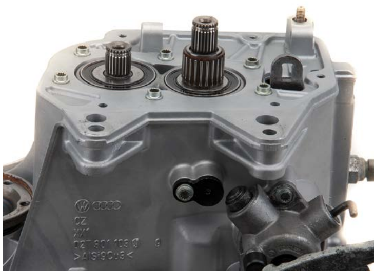
Egy 02T sebességváltó iker- és tűgörgős csapágya
