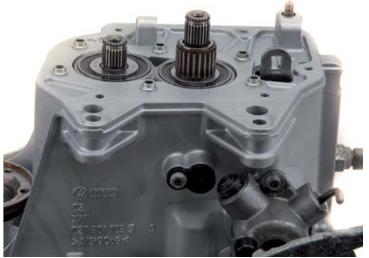
Çıkış milleri montaj plakası düzeneği ve 02T şanzımanın iğneli rulmanı
