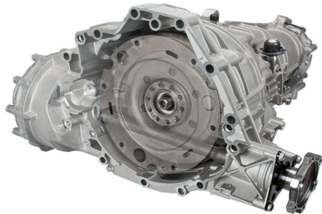
Bei den oben genannten Fahrzeugmodellen werden Getriebe eingesetzt, bei denen das Differential vor der Kupplung seitlich am Gehäuse angeordnet ist. Hierbei verläuft die Vorderachsflanschswelle genau im Bereich des Zweimassenschwungrads (ZMS), bzw. des jeweiligen Drehschwingungsdämpfers (Bild 1). Um den erforderlichen Bauraum zu schaffen, werden Dämpfermodule mit angeflanschten Übertragungsblechen (auch Driveplate genannt) eingesetzt.
