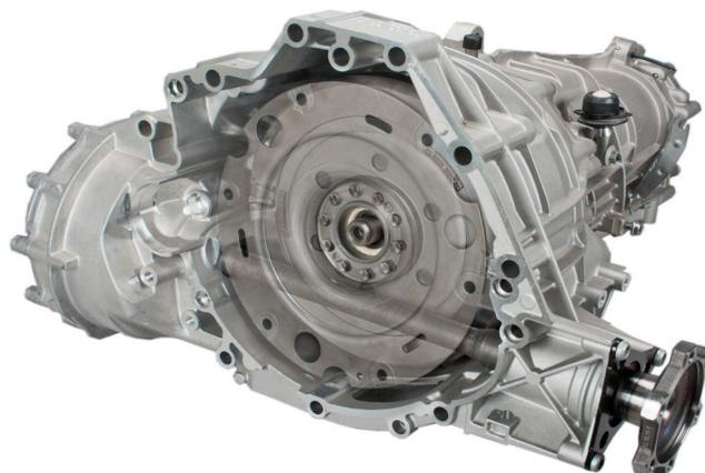
Figura 1: L'albero flangiato dell'assale anteriore passa tra la lamiera di trasmissione e il volano a doppia massa
