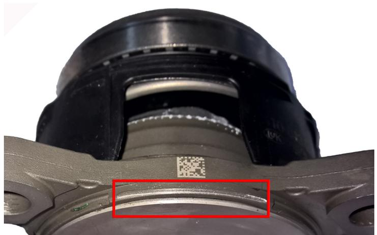
Bild 2: Schadensbild eines Zentralausrueckers mit gelöster Dichtscheibe
