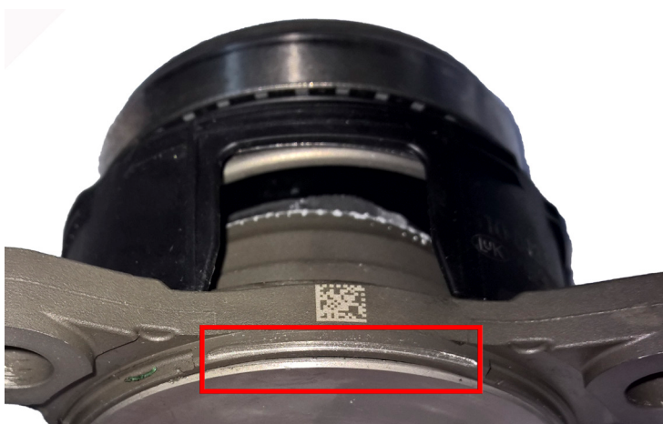
Εικόνα 2: Υδραυλικό ρουλεμάν που έχει υποστεί ζημιά και έχει αποκολληθεί η στεγανοποιητική του βάση
