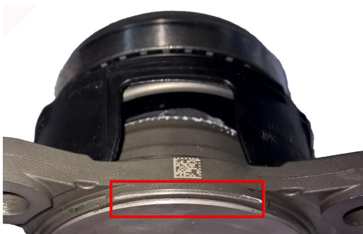
Figura 2: Immagine dei danni all'attuatore concentrico con guarnizione di tenuta allentata
