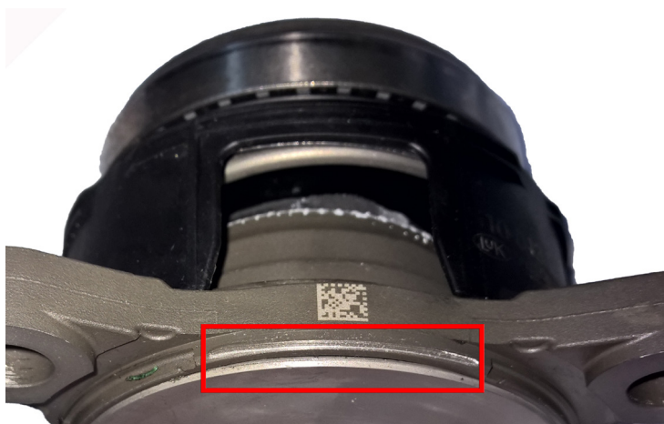
Afbeelding 2: Beschadigingspatroon van een centrale ontkoppeling met geloste afdichtingsschijf
