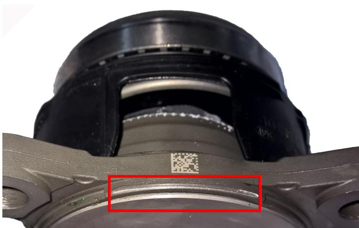
Fig. 2: Rolamento hidráulico com disco obturador danificado
