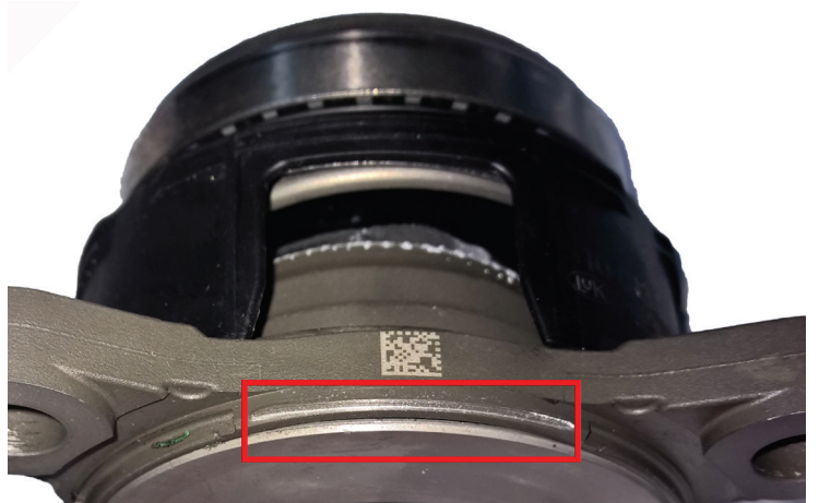
Resim 2: Contası ayrılmış hasarlı debriyaj rulmanı
