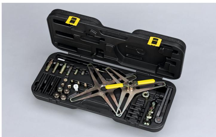
Photo 1 : Outillage spécial réf. 400 0237 10 pour la réparation des embrayages
