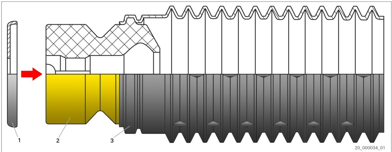
Fig. 1 : kit de service avec capuchon métallique
