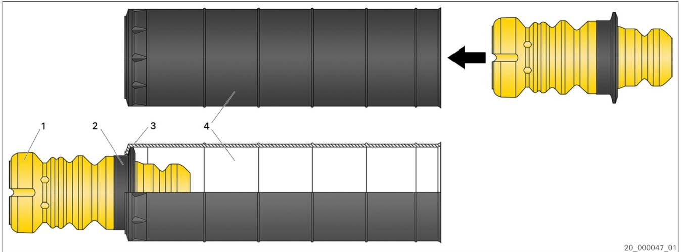
Fig. 1: assemblaggio del kit di servizio (esempio)
