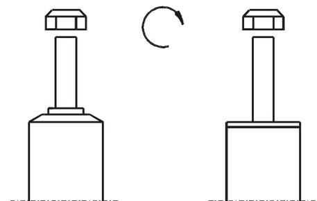
**Um eine mögliche Zerstörung des Produktes zu vermeiden, darf zum Lösen und Anziehen der Muttern kein Schlagschraubendreher verwendet werden. Selbstsichernde Muttern dürfen nur einmal verwendet werden!**
