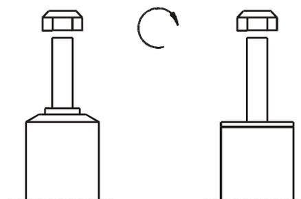
Um eine mögliche Zerstörung des Produktes zu vermeiden, darf zum Lösen und Anziehen der Muttern kein Schlagschraubendreher verwendet werden.
