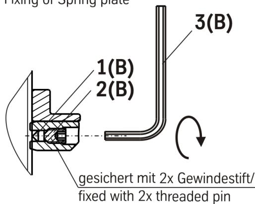
Den Federteller mit der/den im Bilstein Lieferumfang enthaltenen Gummikugeln/Klemmstiften (1), Gewindestift (2) und dem Hilfswerkzeug (Innen-6kt-Schlüssel (3)) sichern.
