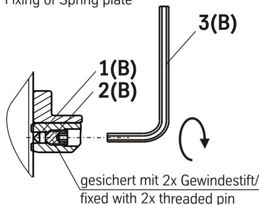
Den Federteller mit der/den im Bilstein Lieferumfang enthaltenen Gummikugeln/Klemmstiften (1), Gewindestift (2) und dem Hilfswerkzeug (Innen-6kt-Schlüssel (3)) sichern.
