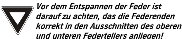
Die Einbaulage der Federn ist an der Bedruckung ablesbar. Die Federbezeichnung Muß in Einbaulage lesbar sein.
