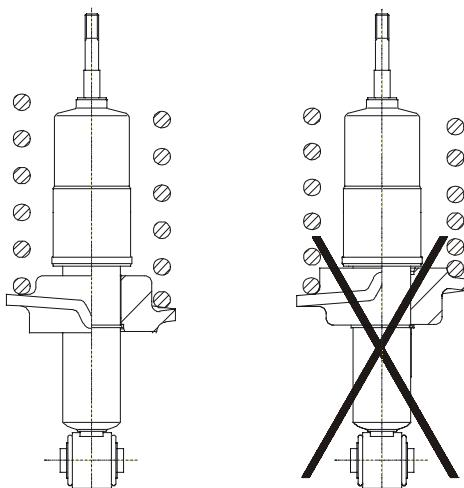
スプリングシートは正しくきちんとお取り付けください。装着が悪いと、必要な長さが得られず、ショックアブソーバー本体が破損します。
