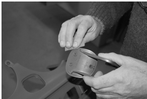
DE: OE-Klappe korrigieren EN: Sanding OE-Cover NL: OE-klepje bijwerken FR: Ajuster cache-OE
