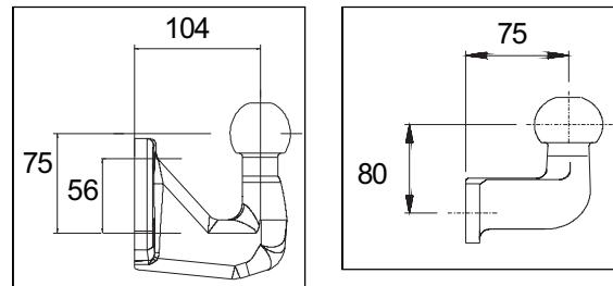
**NL** **Bij gebruik van deze trekhaak met een 2-gats kogel** dient men een EC goedgekeurde kogel te monteren welke voldoet aan een lengte van 75mm, een hoogte van 80mm en aan de minimale D-waarde vlgs. pagina 1.
