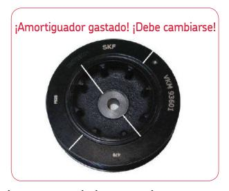
SKF/Equipos originales recomiendan encarecidamente sustituir el amortiguador del cigüeñal y la correa de distribución al mismo tiempo sin esperar a que se averíe el amortiguador.
