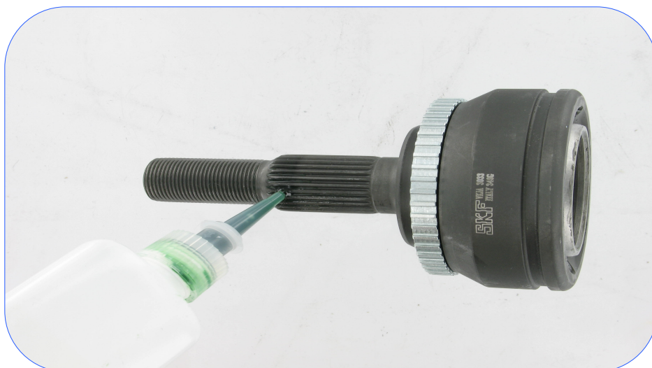
Imagem 1: Aplicação da cola para metal
