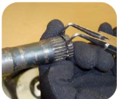
6. Aprite e rimuovete il circlip con le apposite pinze.
