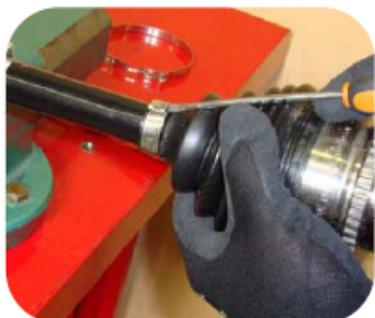
2. Bloccate l'albero della trasmissione in una morsa (con ganasce in alluminio o ganasce di protezione).
