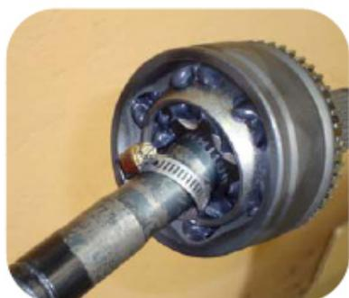
3. Accostate il nuovo giunto all'albero. Fate scorrere il giunto omocinetico sull'albero con dei leggeri colpi di martello fino a quando il circlip si blocca nella sua sede nel nucleo del giunto. Rimuovete la fascetta a vite.
