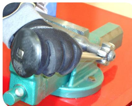
6. Alargue e retire a mola de retenção com alicates para remoção de molas de retenção.
