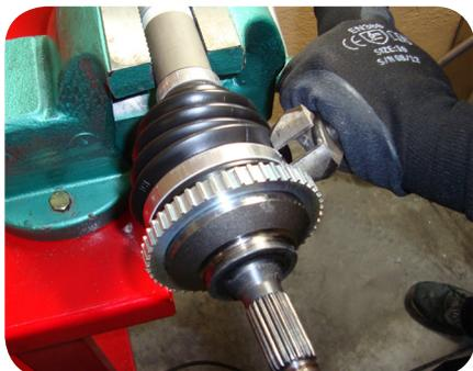
2. Coloque o eixo de transmissão num torno (com dentes de alumínio ou protectores). Retire as molas interior e exterior. Corte o fole e retire-o.
