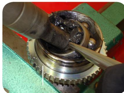
3. Coloque a junta homocinética no torno. Parta o compartimento em vários pontos, ao longo da extremidade (perto das rótulas), utilizando um martelo e cinzel.
