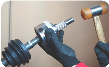
3. Das neue Gleichlaufgelenk auf die Welle pressen.
