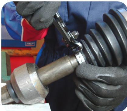
5. Die kleine Schelle am Faltenbalg des Gleichlaufgelenks anbringen und mit der Montagezange verriegeln.
