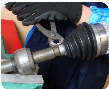
2. Coloque la transmisión en un torno (con mordazas protectoras o de aluminio). Extraiga el clip interior y el clip exterior. Corte el guardapolvos y extráigalo.
