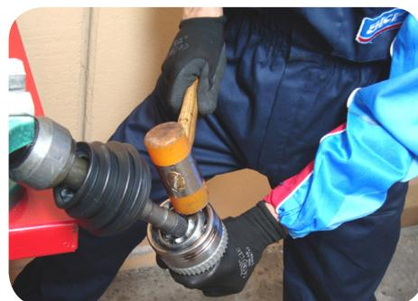
4. Expanda el anillo de retención y extráigalo con la ayuda de unos alicates de extracción para este tipo de anillos.
