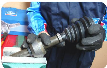
1. Coloque la abrazadera corta del guardapolvos en el eje.
