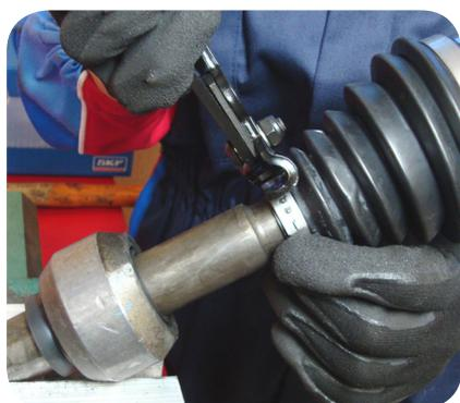
5. Coloque la abrazadera corta en el guardapolvos de la junta homocinética y apriétela con una herramienta apropiada.
