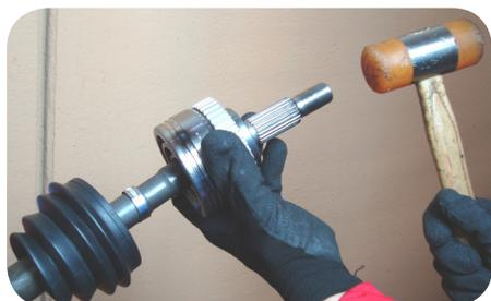
3. Accostate il nuovo giunto all'albero. Fate scorrere il giunto omocinetico sull'albero con dei leggeri colpi di martello fino a quando il circlip si blocca nella sua sede nel nucleo del giunto. Rimuovete la fascetta a vite.
