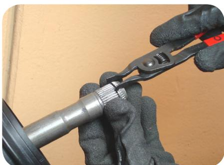
4. Aprite e rimuovete il circlip con le apposite pinze
