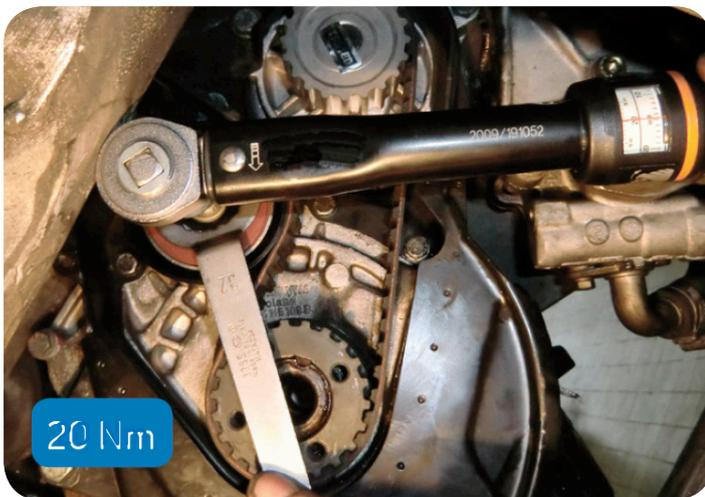
Verifique que a roda da árvore de cames está a rodar enquanto ajusta a tensão. Se não rodar, então a tensão correcta não será mantida e poderão ocorrer danos no motor. Aperte o tensor com binário de 20 Nm. Volte a verificar as marcas de alinhamento.
