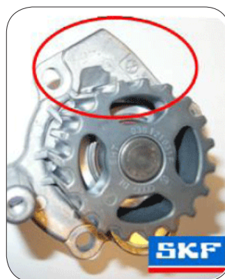
Bomba de água original mais recente
