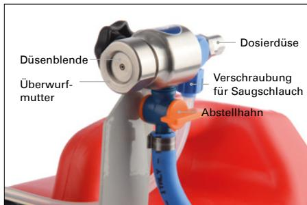
\* Dosierdüsen haben eine definierte Bohrung, die einen festen Mitteldurchsatz ermöglichen. Durch Austauschen gegen eine andere Größe kann der Durchsatz gezielt verändert werden.
