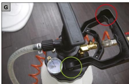
Dépressurisez le réservoir après avoir fermé la vanne d'air, en tirant la poignée carrée sur le couvercle du réservoir (F à G). La soupape de décharge de pression (cercle vert à la fig. G) laisse échapper la pression en émettant un son caractéristique.
