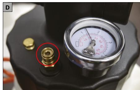
Vérifiez que la soupape de décharge automatique de pression laisse sortir la pression excédentaire ( cercle rouge à la fig. D). Lorsque la pression est trop élevée et doit être abaissée, la vanne émet un son caractéristique.
