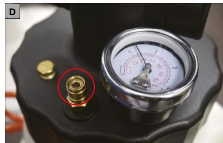
Prüfen Sie, ob das Ventil für automatische Druckentlastung übermäßigen Druck ablässt (rote Markierung in Abb. D). Falls hoher Druck abgebaut werden muss, erzeugt das Ventil ein gewisses Geräusch.
