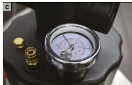
Vérifiez que l'aiguille du manomètre sur le couvercle du réservoir bouge lorsque la pression augmente dans le réservoir (C).
