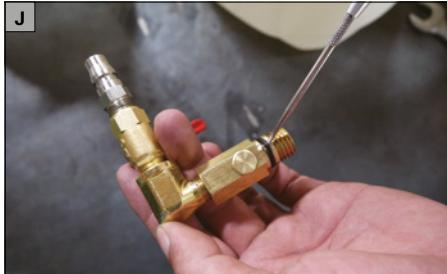
Entfernen Sie den O-Ring, und setzen Sie einen neuen O-Ring ein.
