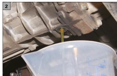
**DE** 2. Wenn Sie die Flüssigkeit vollständig abgelassen haben, setzen Sie die Ablassschraube wieder in die Öffnung ein.
