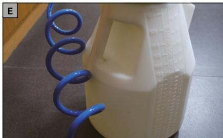
Prüfen Sie während des Druckaufbaus im Behälter, ob der Behälter Undichtigkeiten aufweist (E).
