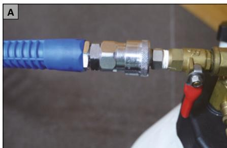
Raccordez l'alimentation en air comprimé de l'atelier au réservoir (A) et actionnez la vanne d'air pour ouvrir ou fermer l'arrivée d'air.
