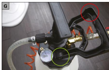
Bauen Sie den Druck im Behälter nach dem Deaktivieren des Luftventils ab, indem Sie den Vierkantgriff am Behälterdeckel ziehen (F bis G). Das Druckentlastungsventil (grüne Markierung in Abb. G) lässt Druck ab und erzeugt ein gewisses Geräusch.
