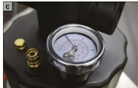
Prüfen Sie, ob sich die Manometeranzeige auf dem Deckel des Behälters bewegt, wenn der Druck im Behälter steigt (C).
