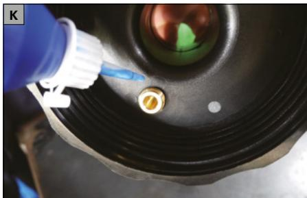
Tragen Sie Schraubensicherungsmittel auf die Mutter auf, und ziehen Sie die Mutter an.
