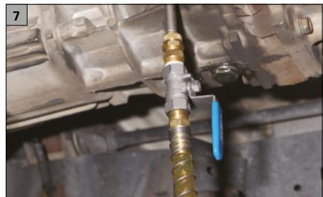
8. Ouvrez la vanne de régulation de liquide à l'extrémité du tuyau en PVC (fig. 8).
