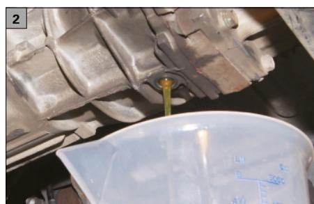
2. Lorsque le liquide est complètement vidangé, revissez la vis sur l'orifice de vidange.
