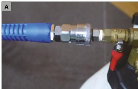
Schließen Sie die Werkstattdruckluft an den Behälter (A) an, und betätigen Sie das Luftventil, um die Luftzufuhr zu aktivieren und zu deaktivieren.
