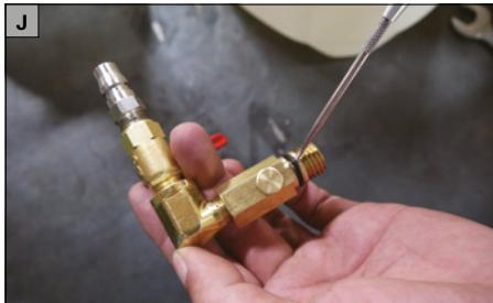
Remplacez le joint torique par un neuf.
