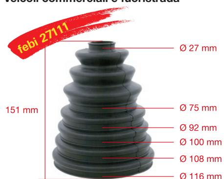
Le cuffie universali possono essere montate sia sul lato trasmissione sia sul lato ruota. Con l'apparecchio di montaggio adeguato le cuffie possono essere estese sino a 10 cm. e rendono possibile un montaggio agevole e rapido!
