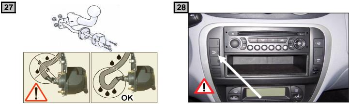
Lors du branchement de la remorque ,désactiver le système "RADAR DE RECUL" au tableau de bord When you connect the trailer, do remove the function "PARK ASSIST" on the dashboard
