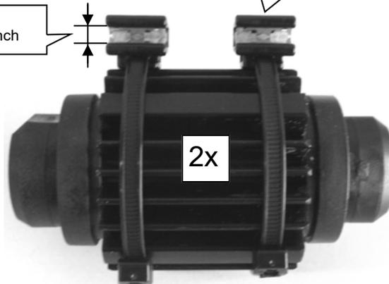
Elektronikbauteil mit Edge Clips an der Kante befestigen. Originale Dämpfersteuerungsleitung in das Elektronikbauteil einstecken. Auf die korrekte Verriegelung des Steckers achten! Anschließend originale Dämpfersteuerungsleitung mit Kabelbindern und Edge Clips 1-3mm befestigen.
