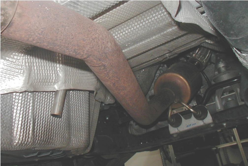
[Abbildung 1] Seriensystem VW T5 Frontantrieb - Abgasanlage mittig
