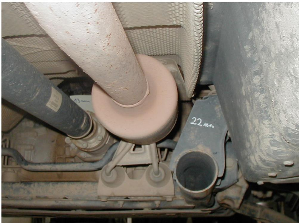
[Abbildung 2] Seriensystem VW T5 Synchro - Abgasanlage rechts
