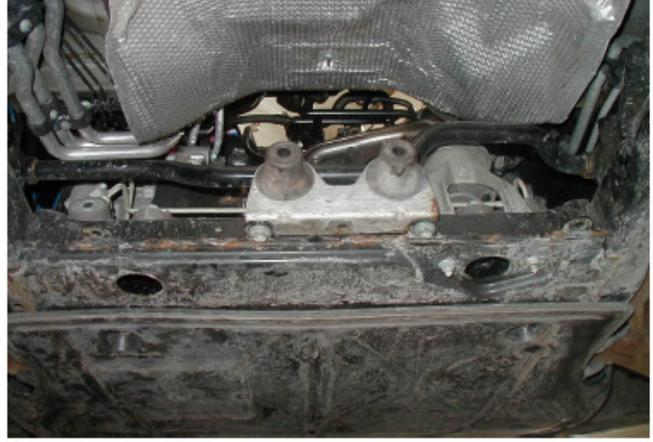
[Abbildung 4] T5 Frontantrieb Halter mitte
