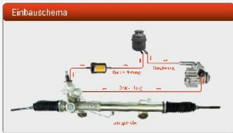
Im Lenkungs-Schutzfilter von MAPCO (Artikelnummer 29990 und 29991) hält ein Hochleistungsmagnet fast 100 Prozent aller magnetischen Partikel fest, im Membranfilterpapier werden die nichtmagnetischen Schwebeteilchen aufgefangen. Das Gehäuse ist absolut dicht und widersteht Steinschlägen sowie Streusalzen.
