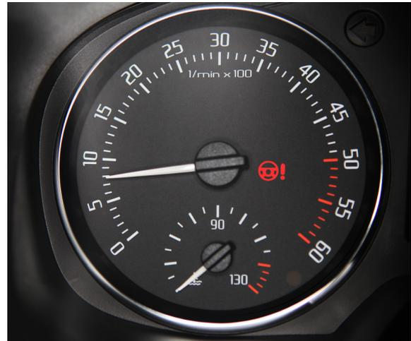
Fig. 1: Luz avisadora do sistema de direção
