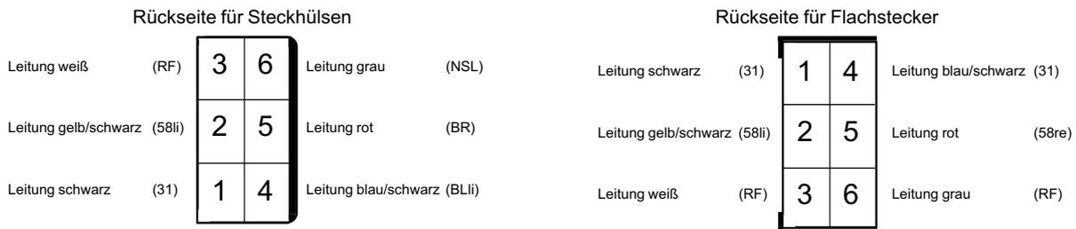
14. Die so fertig montierten Steckergehäuse mit den passenden Gegenstücken vom Leitungssatz zusammenstecken.
