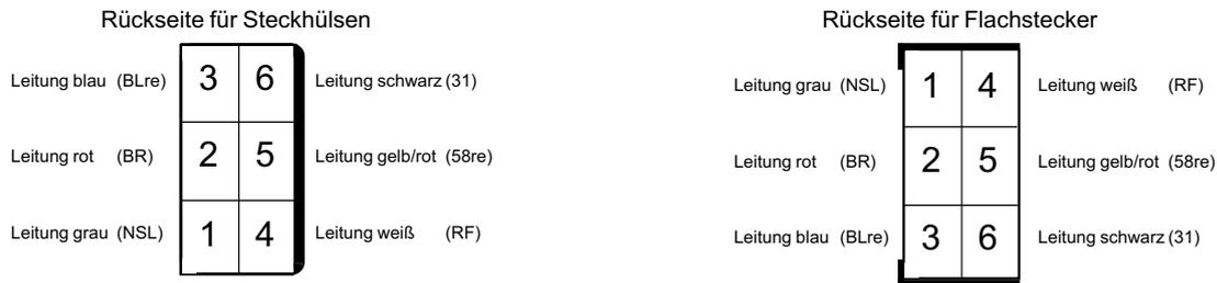
10. Die so fertig montierten Steckergehäuse mit den passenden Gegenstücken vom Leitungssatz zusammenstecken.
