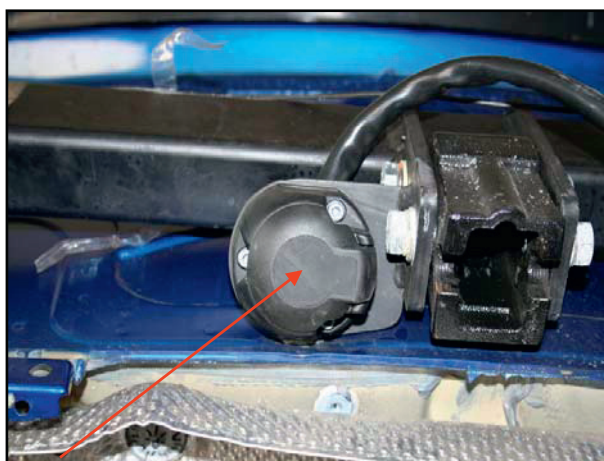
Montage Steckdose Assembly pin socket
