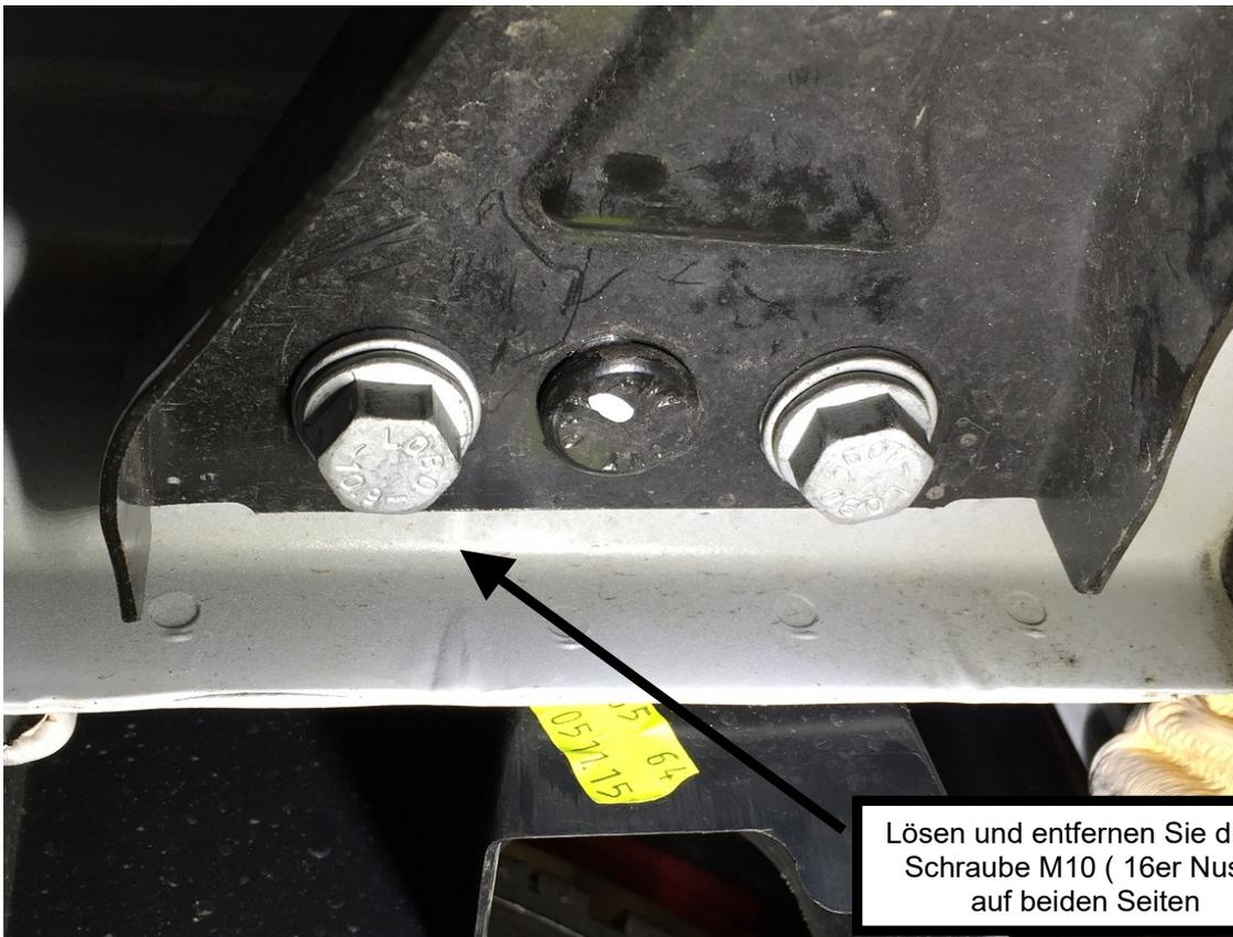
Lösen und entfernen Sie diese Schraube M10 ( 16er Nuss) auf beiden Seiten
