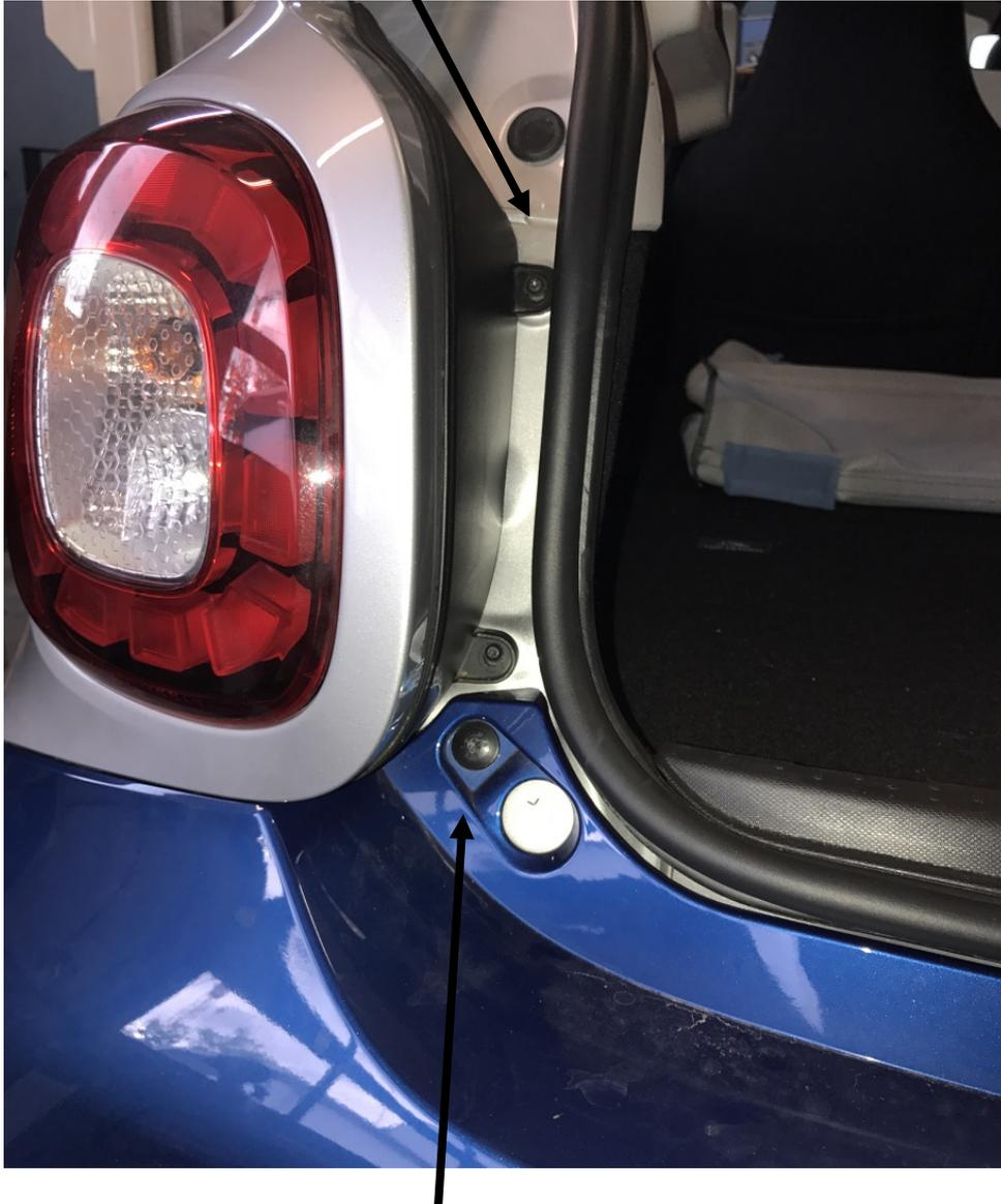
**Entfernen Sie die vier oberen Schrauben**
