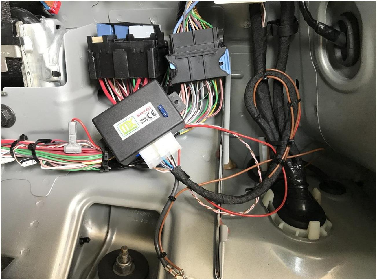
Schließen Sie das Steuermodul an und
