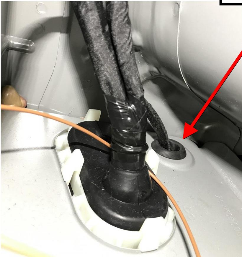
Ziehen Sie diesen Gummistopfen heraus und versehen ihn mit einem Kreuzschnitt in der Mitte. Führen Sie dann das Ende des Kabelsatzes durch den Stopfen und führen das Kabelende durch das Loch.
