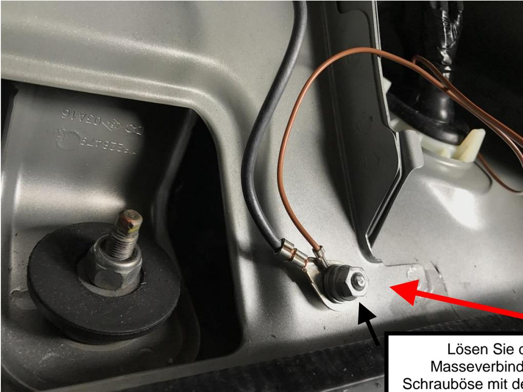
Lösen Sie diese Mutter der Masseverbindung und legen die Schrauböse mit dem braunen Kabel aus unserem Kabelsatz mit auf den Stehbolzen und schrauben die Mutter wieder auf und ziehen diese fest.
