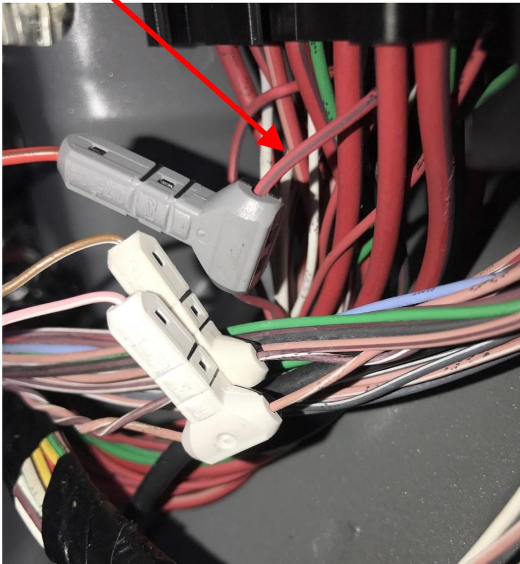
**Sichern Sie nach Anschluss der Kabel mittels Isolierband oder Kabelbinder um die Verbindungen gegen unbeabsichtigtes lösen zu sichern**
