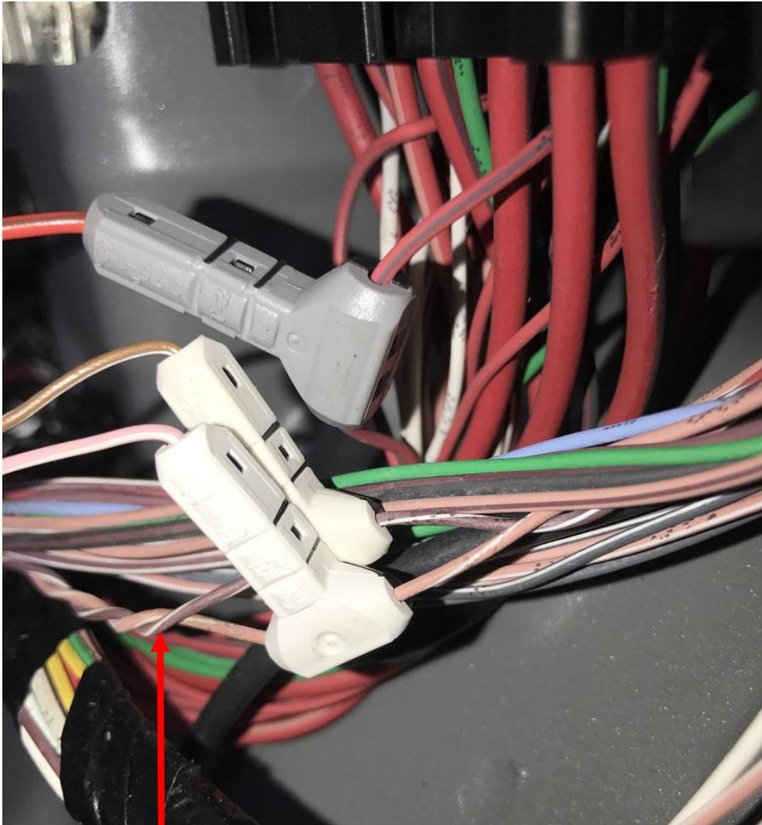
Suchen Sie die beiden miteinander verdrehten Kabel mit den Farben braun/weiß und rosa/weiß, und ziehen diese etwas aus dem Kabelbaum heraus. Verbinden Sie nun die entsprechenden Kabel mit den verdrehten Kabeln aus dem von uns mitgelieferten Kabelsatz mittels den weiss/schwarzen Quetschverbindern.
