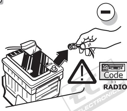
(DE) Um Störungen und Schäden am Bordnetz zu vermeiden, muss die Massepolklemme unbedingt vor Beginn aller Arbeiten von der Fahrzeugbatterie getrennt werden! Insbesondere bei Arbeiten und Anschlüssen am CAN-Datenbus kann bei nicht abgeklemmter Batterie sowohl das Anhängermodul als auch das fahrzeugseitige Bordnetzsteuergerät beschädigt werden! Bitte Herstellervorschriften beim Ab- und Anklemmen der Fahrzeugbatterie beachten!
