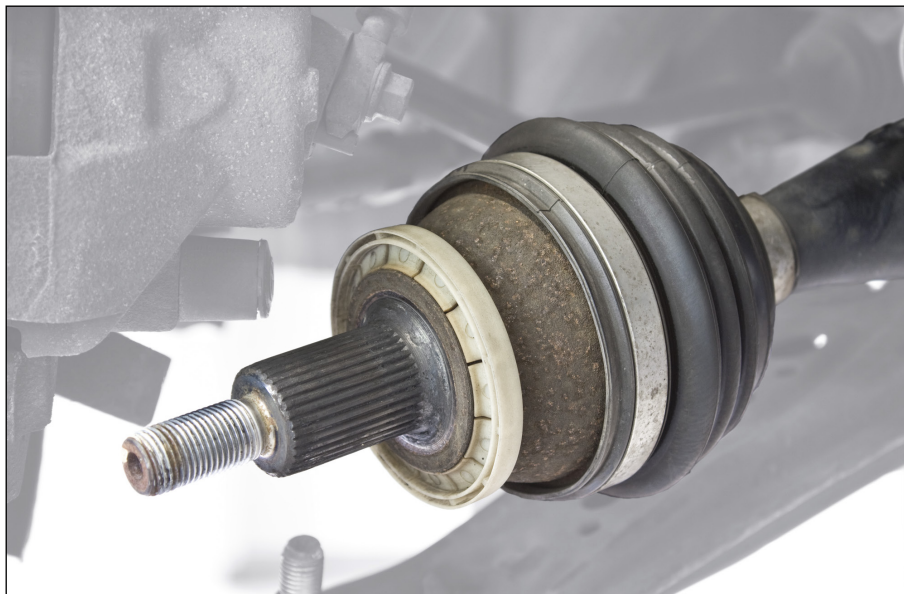
Bild 1: Tättningsringarna kan variera i design och färg!
